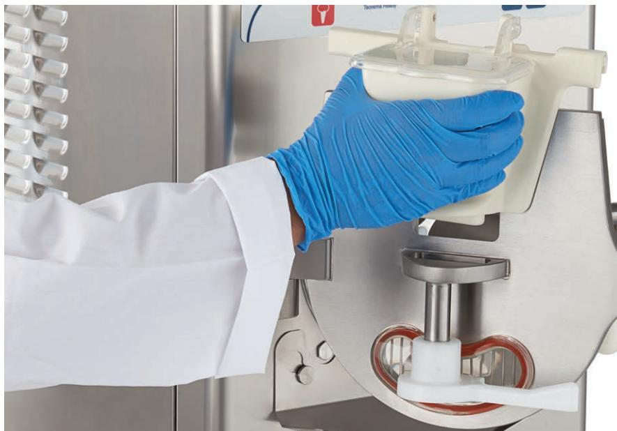
**Portello con tramoggia in plastica smontabile** per una maggiore facilità di pulizia. Il nuovo design della bocca di entrata facilita l'inserimento degli ingredienti così come la nuova forma della bocca di uscita velocizza l'estrazione del gelato.
